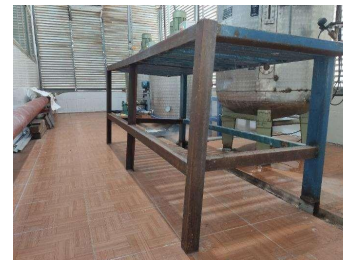
Giá đứng để đổ hoá chất thủ công, tiềm ẩn nguy cơ trượt ngã của nhân viên vận hành
