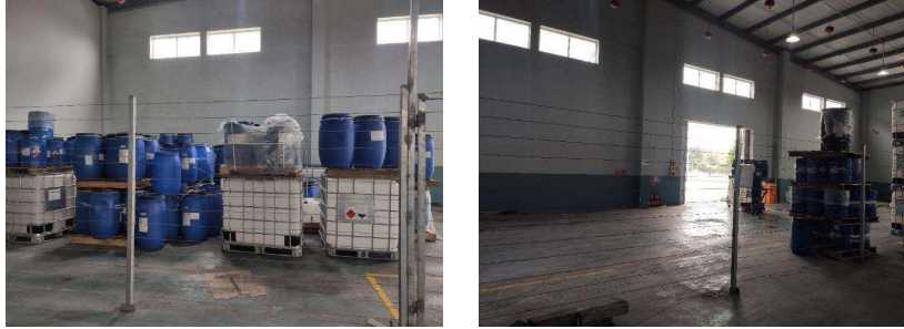
Khu vực lưu giữ thùng chứa hoá chất sau khi sử dụng không được tách biệt với kho chứa hoá chất chưa sử dụng
